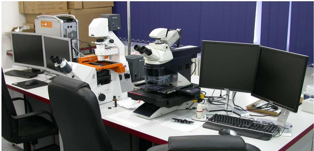
*Zona de imagistică moleculară este constituită din sistemul de microdisecție microscopică laser (dreapta) și din stația de lucru automatizată de microscopie pentru citometrie tisulară și histologie cantitativă în aplicații de imunohistochimie și imunofluorescență (stânga)*
